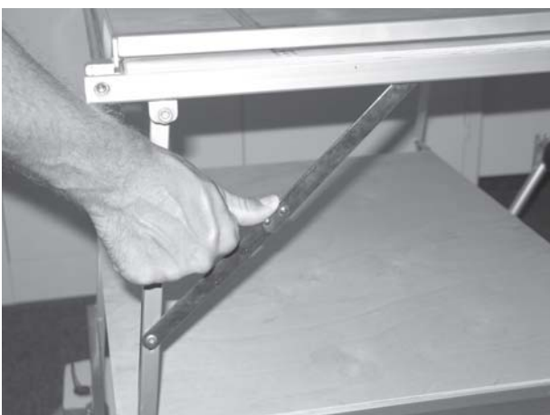
Stůl stroje vyklopte a nechte zaklapnout jeho zajištění.
