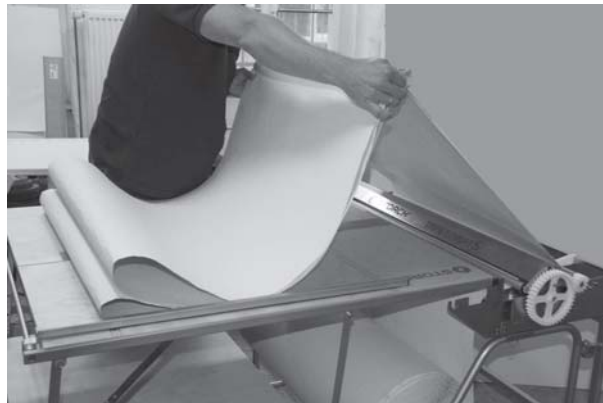
Lors des travaux avec la table de la machine, plier soigneusement le papier peint encollé à la longueur de la table.
