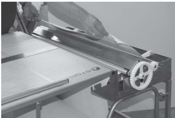
Zatvorte kryt a tapetu ťahajte nad vekom (plocha s naneseným lepidlom ukazuje smerom hore) cez prístroj na lepenie, kým nebude dosiahnutá požadovaná dĺžka.
