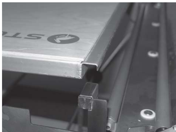
Vyklopený stůl položte s profilem U na čtyřhranné profily držáku tapet.
