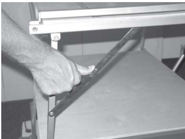
Stôl pod stroj rozložte a zaistite zablokovanie.
