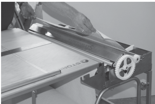
Sluit de deksel en trek het behang gelijkmatig over de kap (ingesmeerde kant boven) door het apparaat totdat de gewenste lengte is bereikt.
