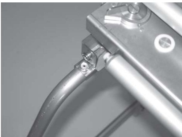
Vyklopte stojan a nejmenší přístroj s úchyty nasuňte na oka, až se magnety na zadní straně přichytí na rámu.
