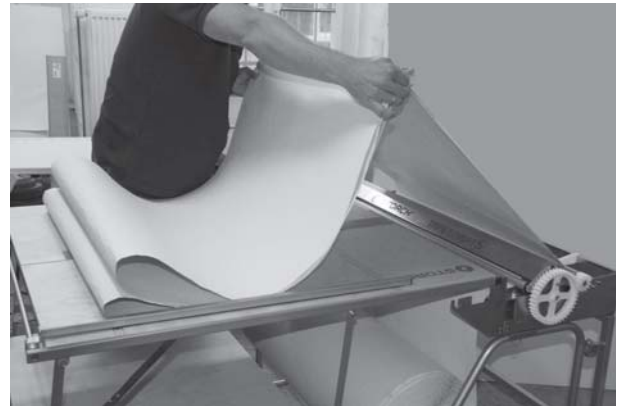
Bei Arbeiten mit dem Maschinentisch die eingekleisterte Tapete in Tischlänge zusammenlegen.
