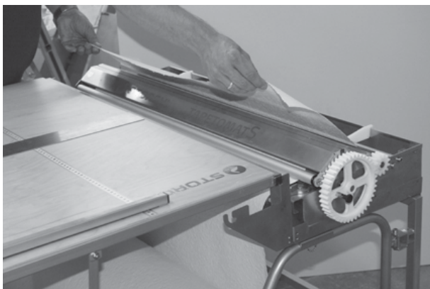
Fermer le couvercle puis tirer régulièrement le papier peint sur le capot (la partie encollée vers le haut), à travers l'encolleuse, jusqu'à atteindre la longueur souhaitée.
