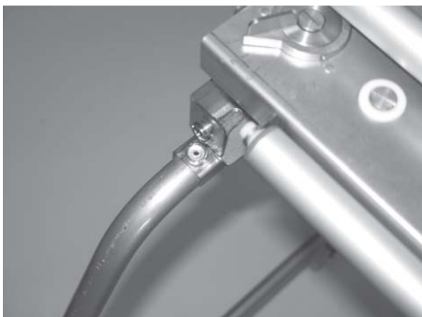
Podstavec odklopte a prístroj na lepenie posúvajte s uchyteniami cez oká, kým magnety na zadnej strane sa neprichytia na rám.
