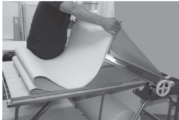
Pri práci so stolom pod stroj tapety s naneseným lepidlom zložte na dĺžku stola.
