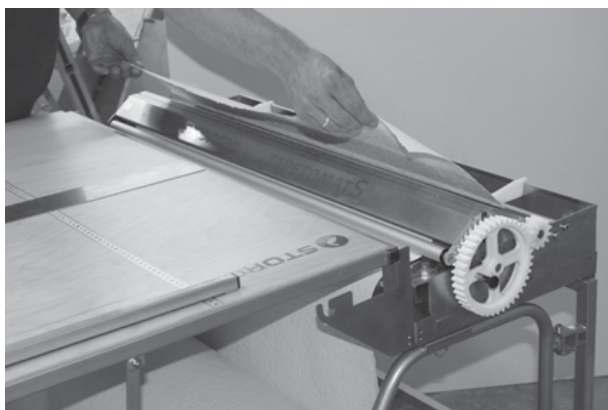
Uzavřete víko a tapetu stejnou rychlostí protahujte přes kryt (lepidlem pokrytá strana směřuje nahoru) zařízením na nanášení lepidla až do požadované délky.
