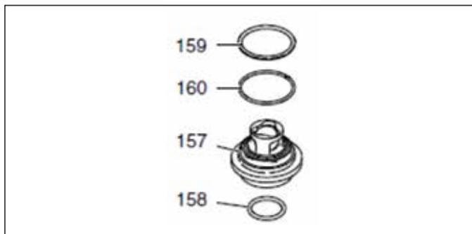
Attention : unité de soupape d'admission modifiée avec les systèmes d'aspiration LP 500 F et LP 600 F. Les pos. 157, 158, 159, 160 remplacent 5, 6, 7, 8a, 8.
